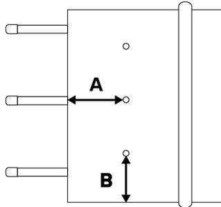
**Distance du bord de la toile jusqu'aux trous d'évacuation d'eau (en cm)**
