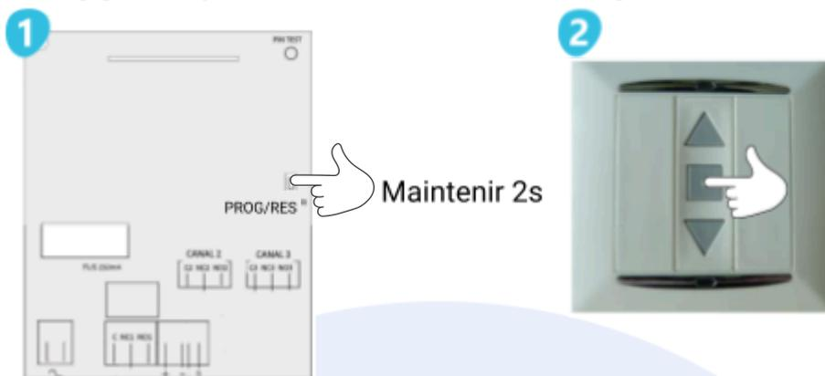
Appuyer sur le bouton "PROG/RES" pendant 2 secondes au minimum, jusqu'au signal sonore
