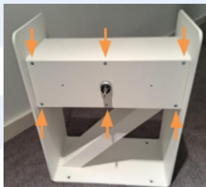
Retirer l'habillage et dévisser les 6 vis de la trappe sur le pied côté moteur.
